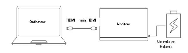
Questo monitor è dotato di una porta HDMI, collegare la porta HDMI di questa unità e la porta HDMI del computer. Collegabile anche con un cavo di tipo C o l'adattatore CA per l'alimentazione.
